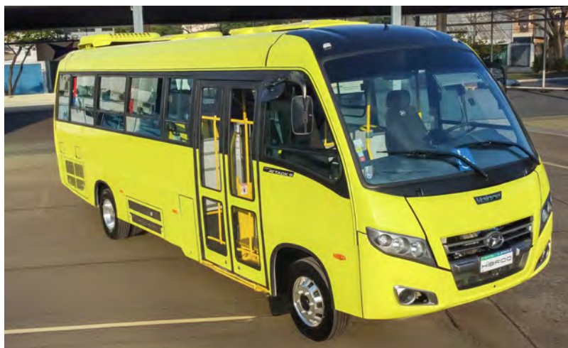
A Marcopolo apresentou o Volare Attack 9: elétrico híbrido flex com motor Horse e gerador WEG.
