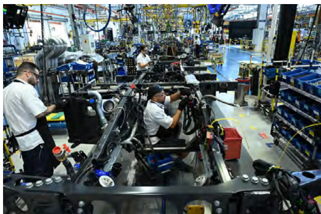
Scania já prepara linha de produção em São Bernardo para fazer dois chassis de ônibus elétricos por dia a partir de março de 2025
